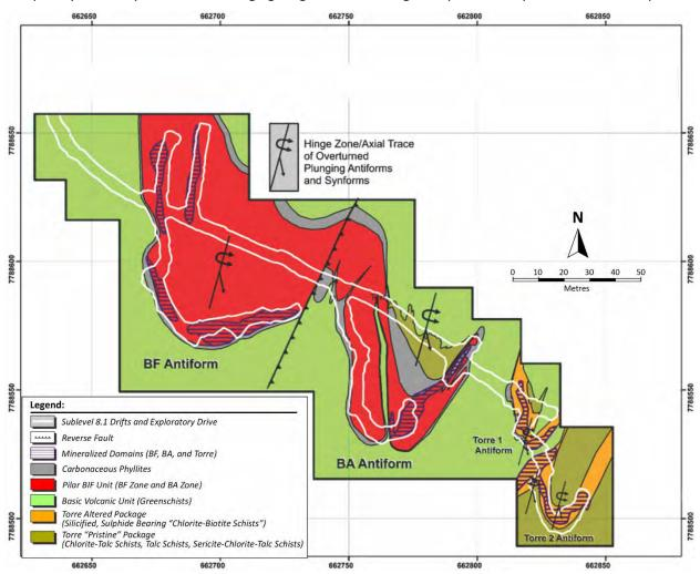
Figure 7-16: Schematic Geological Setting –Torre Sublevel 8.1
