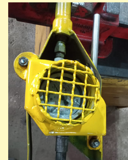
Manômetro de bomba protegido
