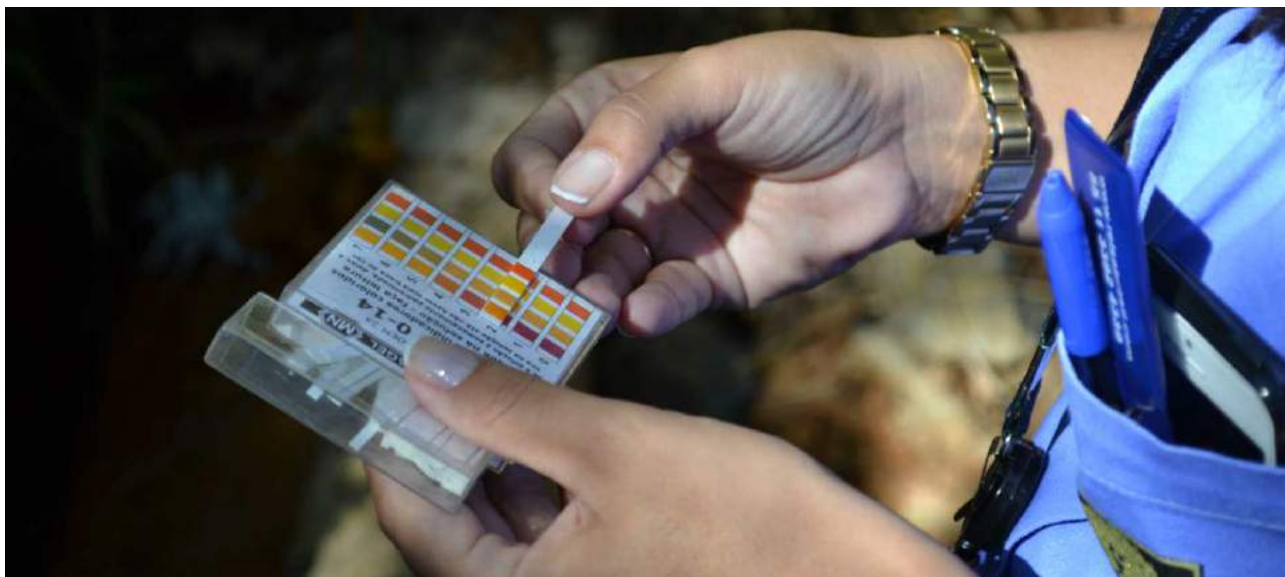
Análise de PH para controle de drenagem ácida - Unidade CPA / Arquivo Jaguar Mining
